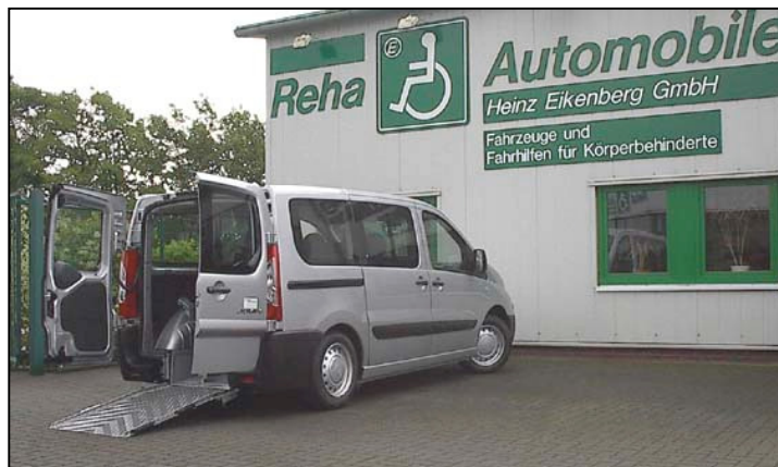
Fahrzeug einfahrbereit abgesenkt
