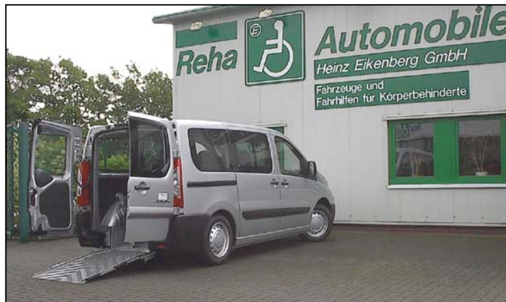
Fahrzeug einfahrbereit abgesenkt
